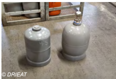
© DRIEAT Bouteilles BP normale (à gauche) et déformée suite au test d'étanchéité (à droite)
