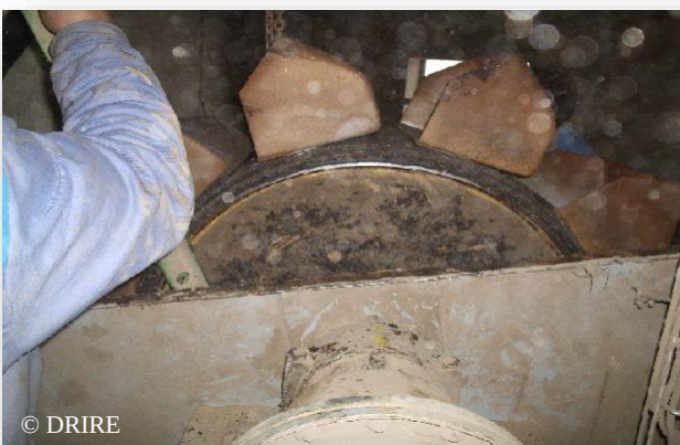
Tête d'élévateur à godet - ARIA 31062
