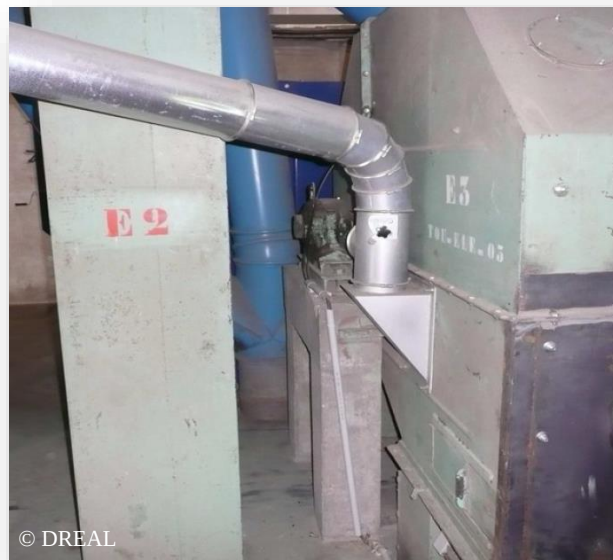
Aspiration de poussières en tête d'élévateur
