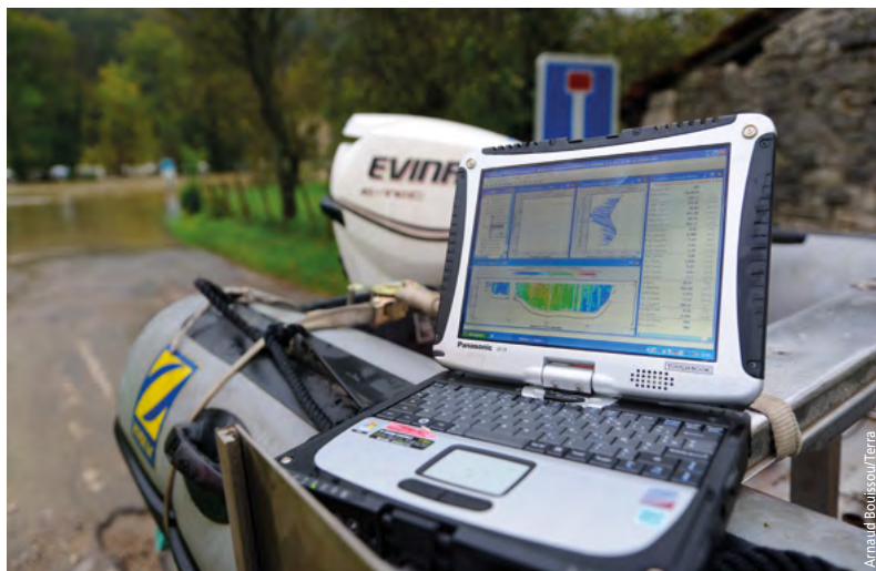
Relevé de mesures hydrométriques sur le Doubs en crue.
