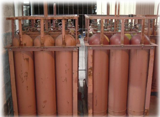
Cadre de bouteilles d'acétylène similaire à celui impliqué dans l'accident © DRIRE RA/DCT
