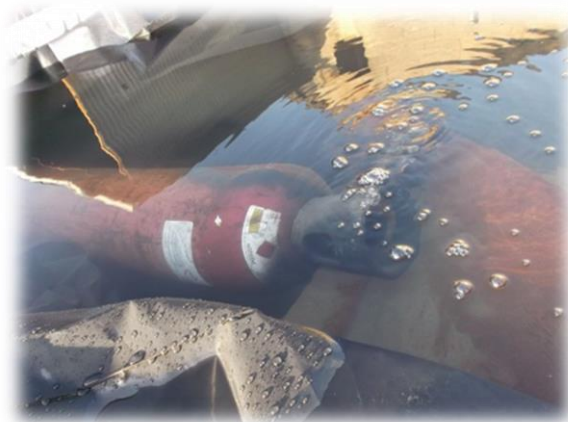
Dégazage de la bouteille d'acétylène (© DRIEE)
