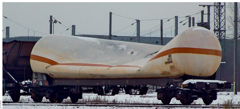
◀ Compression d'un wagon-citerne de butadiène sous l'effet du froid.
