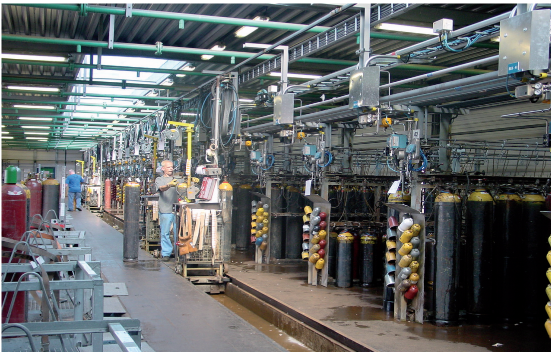
Chaîne automatisée d'embouteillage de gaz industriels (source : Emerson Process)
