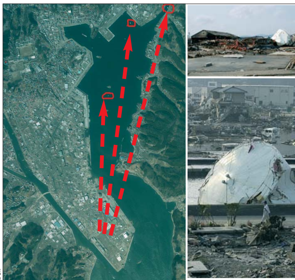
Fig. 1 - Dépôt pétrolier de Kesenuma : trajectoire des bacs emportés par la vague
