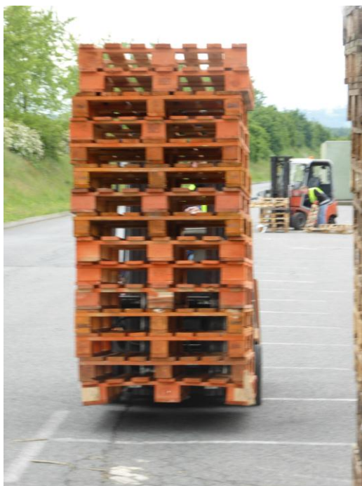
Manutention d'un lot de 15 palettes avec un chariot (source : BARPI)
