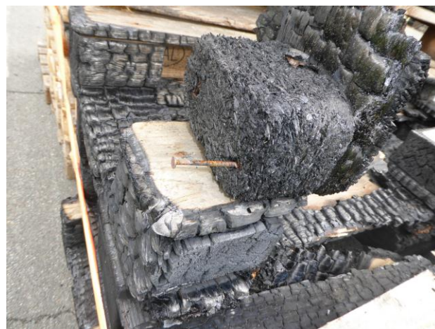
Clou dépassant d'une palette brûlée (source : BARPI)
