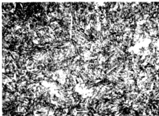
Structure matensitique aciculaire de l'acier de la bouteille après attaque au Nital – Droit réservé
