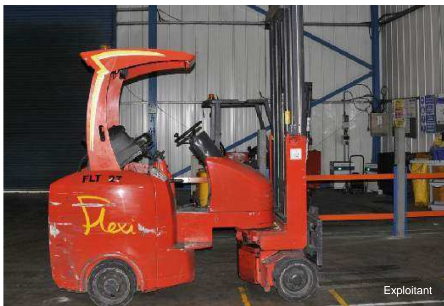
Figure 2 : Chariot élévateur électrique non protégé, utilisé sur le site
