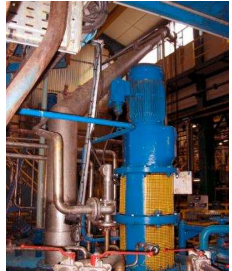
Partie haute du réacteur : mélangeur et conduit d'évacuation du disque de rupture
