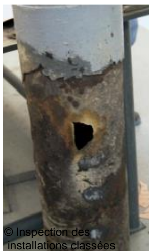
Corrosion externe du tube et endommagement du revêtement protecteur
