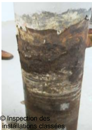
Corrosion externe du tube et endommagement du revêtement protecteur
